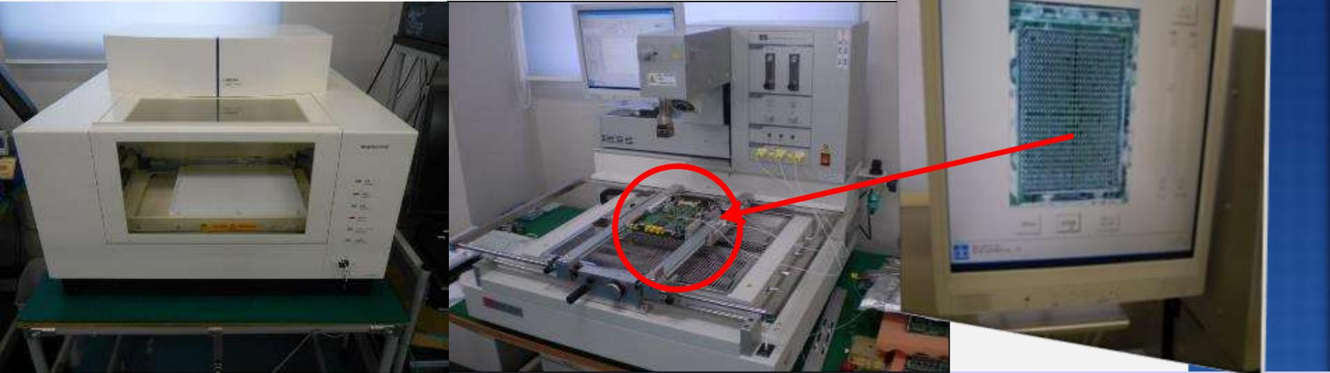
バウンダリスキャンで検出したBGAの不具合状況を的確に確認し、
